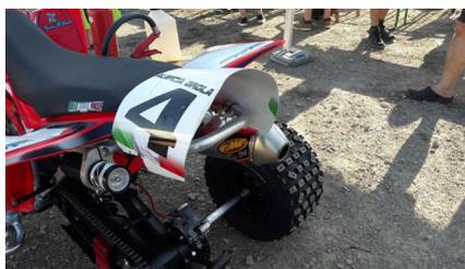
La transmission assurée par une chaîne est équipée d'un sabot ou carter (présence obligatoire) à sa partie inférieure protégeant la couronne et le disque. Un pare-choc ou bumper AR est mis en place. Dans le cas d'un pare-choc, les deux embouts sont arrondis, diamètre des tubes 15 mm minimum. La largeur hors tout du quad ne doit pas excéder 1300 mm.
